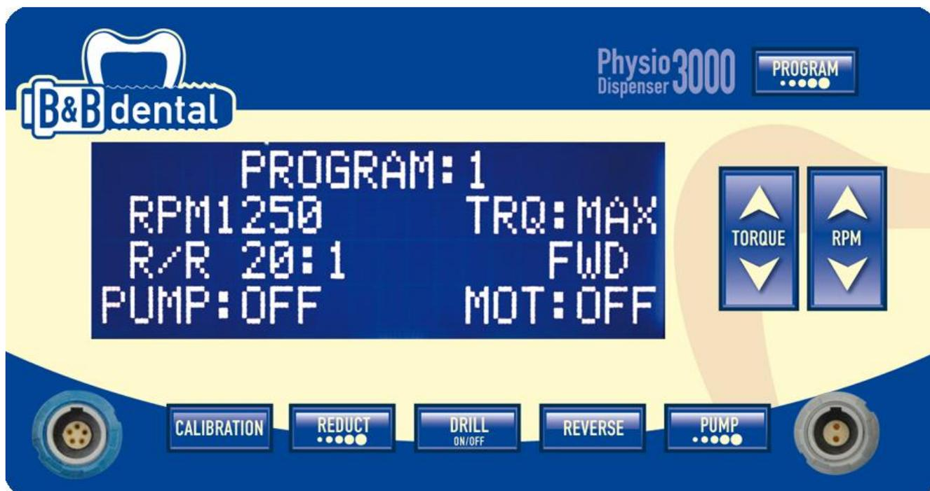
1. **ДИСПЛЕЙ:** легко читаемый алфавитно-цифровой многофункциональный экран. 4-строчный дисплей для визуализации всех функций.
